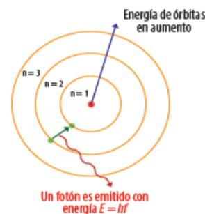
Bohr estableció valores energéticos para las órbitas en las cuales se encontraban en movimiento los electrones. Adaptado de [https://es.wikipedia.org/wiki/Modelo\\_at%C3%B3mico\\_de\\_Bohr](https://es.wikipedia.org/wiki/Modelo_at%C3%B3mico_de_Bohr) Recuperado el 13 de septiembre de 2016.
